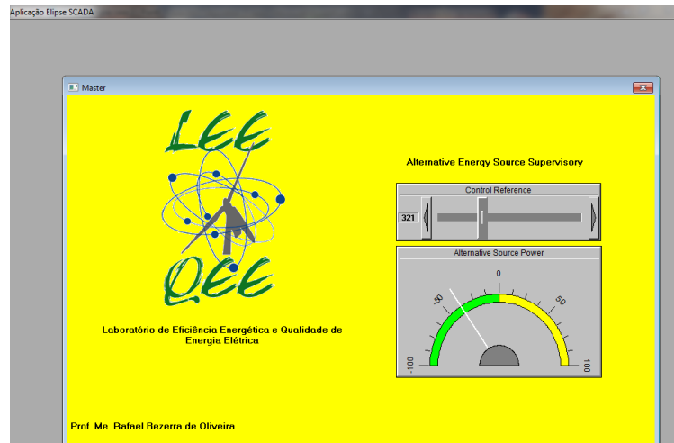
Figura 11 – Aplicação do software Elipse com fluxo de energia positivo e fornecendo energia para a carga. Fonte: OLIVEIRA, 2012.
