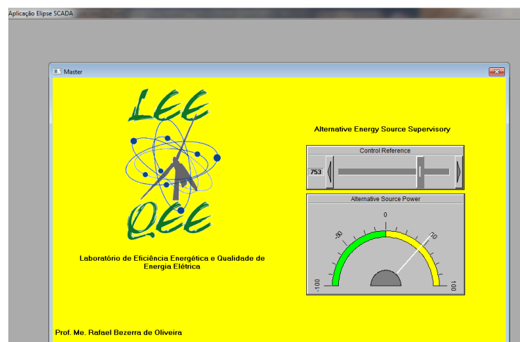
Figura 8 – Aplicação do software Elipse com fluxo de energia positivo e efeito boost . Fonte: OLIVEIRA, 2012.
