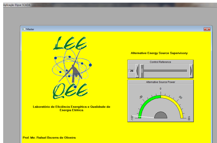
Figura 13 – Aplicação do software Elipse com fluxo de potência negativo. Fonte: OLIVEIRA, 2012.
