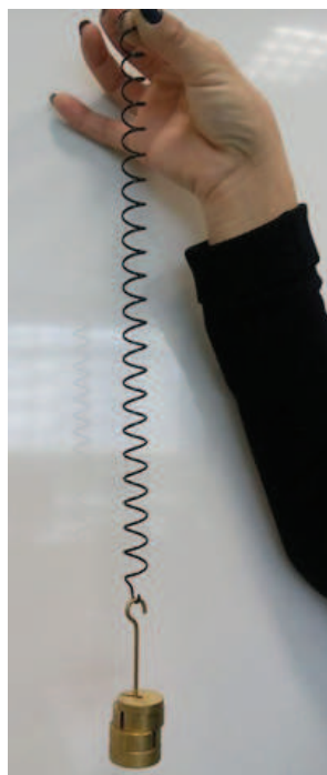
Figura 2 - Mola deformada por uma massa suspensa.
