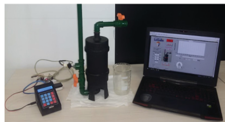
Figura 08: Permeâmetro digital de solos.
