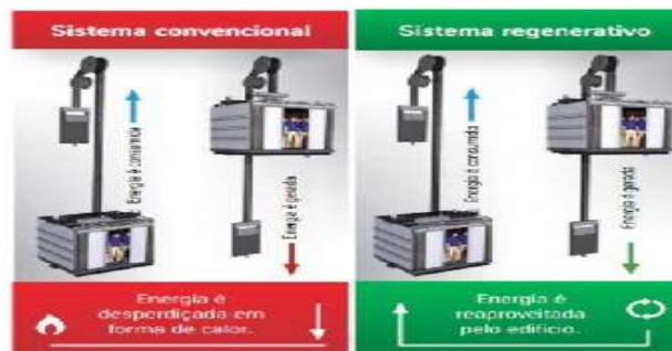
Figura 6- Sistema Regenerativo nos Elevadores do CAS.
