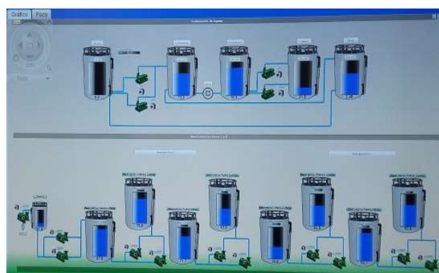
Figura 3- Reservatórios de Água para Irrigação do Paisagismo.
