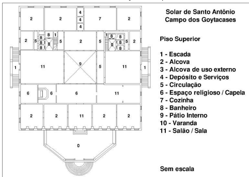
Figura 1. Planta Baixa do Solar de Santo Antônio em Campos dos Goytacazes (RJ).
