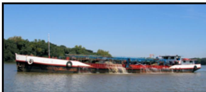
Figura 6. Draga de sucção autopropulsada em atividade de exploração de areia.
