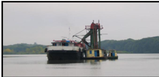
Figura 5. Draga de alcatruz em carregamento de barco tipo “chata”.
