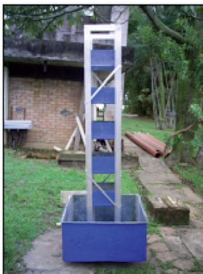
Figura 2. Aerador tipo tabuleiro em fibra de vidro e estrutura em alumínio confeccionado para a ETA-Piloto.
