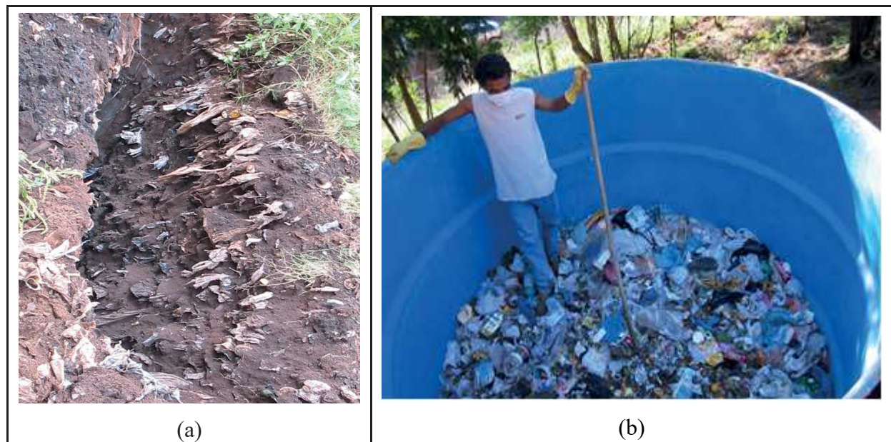
Figura 1. (a) Detalhe das condições do RSU estabilizado coletado no Lixão do Município de Visconde do Rio Branco - MG; (b) Preenchimento do reservatório produtor de percolato a partir de RSU recém-coletado na cidade de Viçosa - MG.
