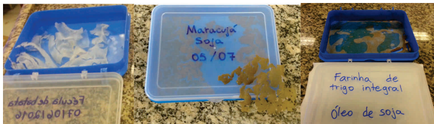
Figura 2 – Bioplásticos feitos a partir de fécula de batata/farinha de maracujá/farinha de trigo integral e óleo de soja.
